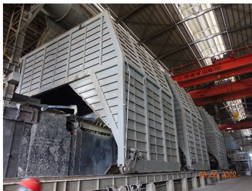
(1) ระบบรวบรวมฝุ่นหรือฟุ้งอากาศร้อน
