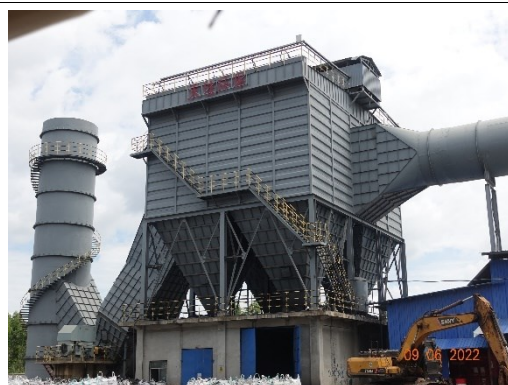
(3) เครื่องดักฝุ่นแบบถุงกรอง
